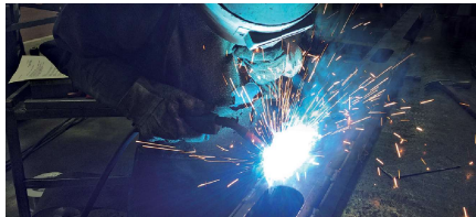
バスのフレーム部品溶接例 (FAMILIARC SE-1Z 使用)
